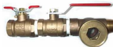
进水口侧球阀为“开/关”两位式,阀体带水流方向指示标志。中间球阀为“开/测试”两位式,当两个阀门置于“开”位置时,相当于 DN25(或 DN32 或 DN50)球阀,当置于“测试”位置时,相当于 DN15 喷头的流量系数。在设计选用时应在进水侧配套安装水压表。
