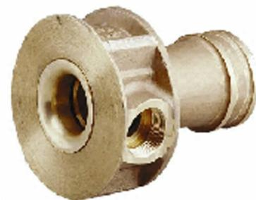
浓缩液比例混合器为一改良的文丘里装置。当水流经文丘里装置时,会由于计量压力降而产生一个低压区。当经过文丘里装置的水流量增大时,则计量压力下降更大使得更多的泡沫液经喷管流入。当经过文丘里装置的水流量减少时,则计量压降减少,从而使得进入泡沫浓缩液的流量减少。由于泡沫浓缩液流量的变化与水流成比例关系。因此浓缩液比例混合器与各种水流量速率之间具有精确的比例关系。当计量压降在某一速率上刚好可以克服经过管道及泡沫罐的压力损失时,将该速率称为低的定额流量值。要将泡沫正确配比,经比例混合器的流率必须等于或高于低流率额定值。
